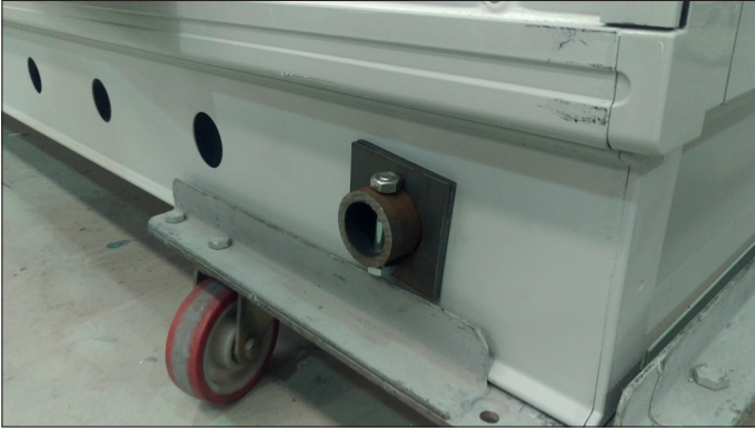
Şekil 7. Kaldırma çubuklarının bağlanması - 3
