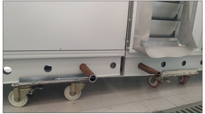
Şekil 12. Dış açılmış çubuk kullanarak bölümleri birleştirmek
